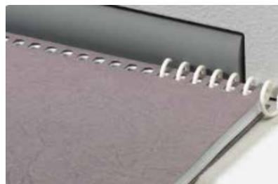
Le rouleau en caoutchouc, simple d'utilisation, fait passer la bobine à travers le document de manière rapide et efficace.
