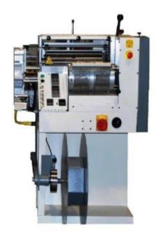
Unicoil CF - Formeuse automatique de spirales en plastiques : cette machine permet de contrôler entièrement la finition des spirales en plastique en permettant de former des spirales en palstique de toutes tailles (de 10 à 1200 mm) à partir de bobines de filament droit.
